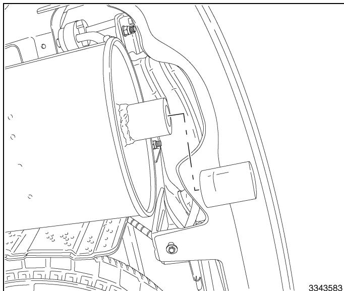
5. Deslice la punta de escape cromada en el tubo del silencioso con el orificio piloto orientado hacia abajo.
