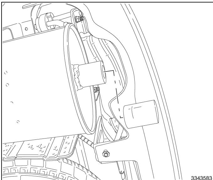
5. Glisser le l'embout de tuyau d'échappement chromé sur l'embout de pot d'échappement avec le trou d'implantation orienté vers le bas.
